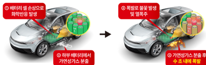
전기차 화재 발화지점 및 발생 과정
